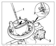
15.41 Checking choke valve gap (pull-down)
